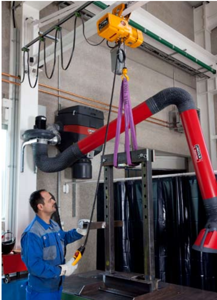
Elektrokettenzug ER2 mit Frequenzumrichtertechnologie mit einer Traglast von 500 KG für das gefühlvolle Handhaben von Lasten an Schweißarbeitsplätzen bei Indukran, Andernach.
